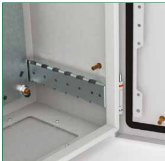
Soporte para cableado, formación de una estructura interior y regulación de la profundidad con intervalos de los accesorios de 25 mm gracias a Guías de fijación universales (con fijación delantera a escuadras universales).
